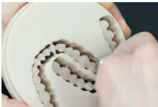
Heraustrennen der gefrästen Zahnkränze mit geeigneten Werkzeugen wie z.B. einem Hartmetallfräser.
