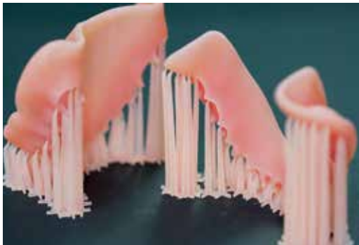
3D-gedruckte Prothesenbasis aus V-Print dentbase.
