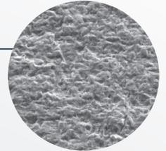
Oberfläche der o.g. Kavität bei 500 facher Vergrößerung. Die Oberflächenstruktur wird gleichmäßig über die ganze Kavität aufgeraut
