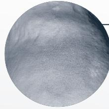
Kavität nach 60 Sekunden Bestrahlung mit 50 µm-Pulver. Sehr gute Abtragsleistung und klare Konturen erkennbar
